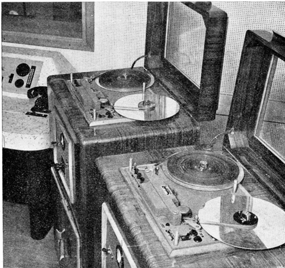
Fig. 12.20. - Registratori magnetici a nastro usati dalla Radio Italiana per le registrazioni da studio. Velocità del nastro: 38,1 cm/sec, oppure 76,2 cm/sec. Gamma acustica da 50 a 10.000 sino a 15.000 c/s, più o meno un decibel. Dinamica di registrazione di 50 dB. Questi apparecchi superano in perfezione qualsiasi altro sistema di registrazione attualmente esistente, compreso il film sonoro. I radioascoltatori non hanno la possibilità di distinguere tra un programma musicale diretto ed uno registrato, al contrario di quanto avviene per i dischi. A seconda delle dimensioni, le bobine consentono registrazioni da 20 a 35 minuti, senza interruzione.
