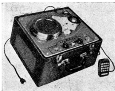
Fig. 12.33. - Piccolo registratore magnetico a filo adatto per scolari e per il «diario sonoro». È costruito dalla Air King. Il principio di funzionamento è illustrato dalla fig. 12.34.
